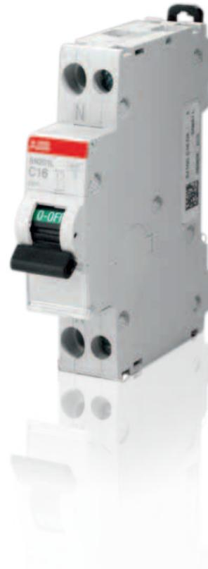
La gamme SN201 est équipée de bornes spécialement étudiées pour permettre un accès simple avec tournevis isolé. Ce produit facilite également le changement d'un appareil sur rail DIN, sans décâblage des autres via un système ingénieux d'accroche bistable, même s'il est placé au milieu d'une rangée. Cette version permet un gain de temps tout en gardant une fiabilité de connexion.
